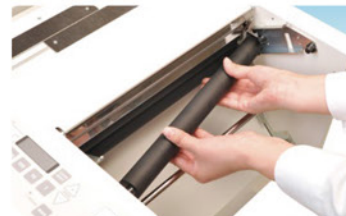
快速装卸压纸辊，让日常维修与清理更方便
